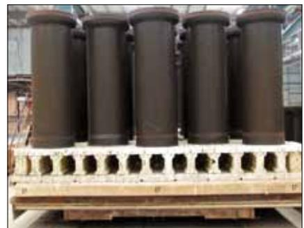
Рис. 8. Трубы перед обжигом на садочных кольцах
