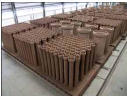
**Рис. 1.** Сушильная тележка с различными трубами
