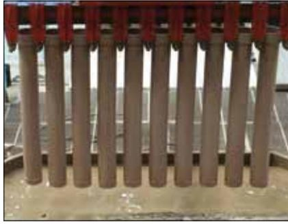
Рис. 5. Процесс глазурирования
