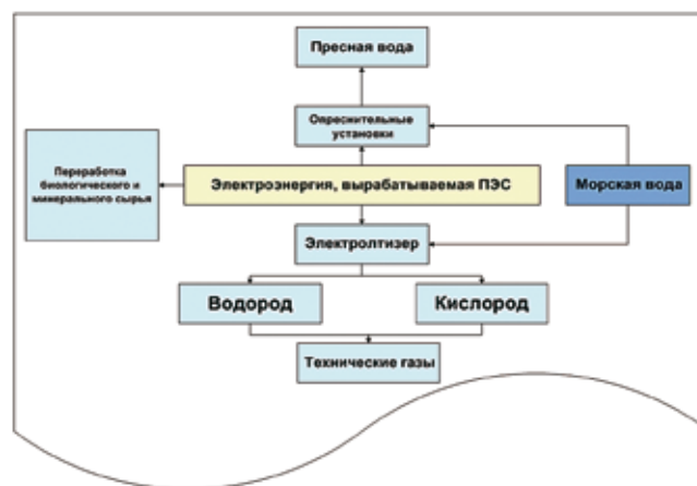
Рис. 1. Схема утилизации электроэнергии, вырабатываемой ПЭС
