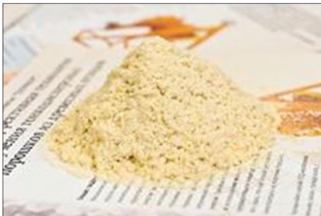
Рис. 10. Древесная мука, полученная в аппарате с 20 пульсационными камерами статора
