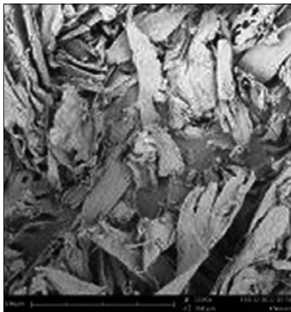
Рис. 7. Электронно-микроскопическое изображение древесной муки, полученной на комбинированной мельнице-нагревателе с 20 пульсационными камерами (увеличение 1000х, размерная шкала 130 мкм)
