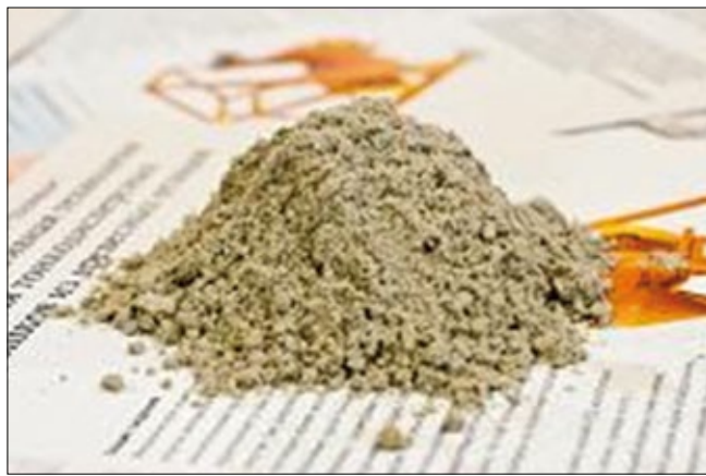
Рис. 11. Древесная мука, полученная в аппарате с 50 пульсационными камерами статора
