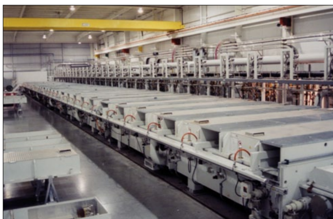
Рис. 1. Линия по нанесению покрытий методом магнетронного напыления
