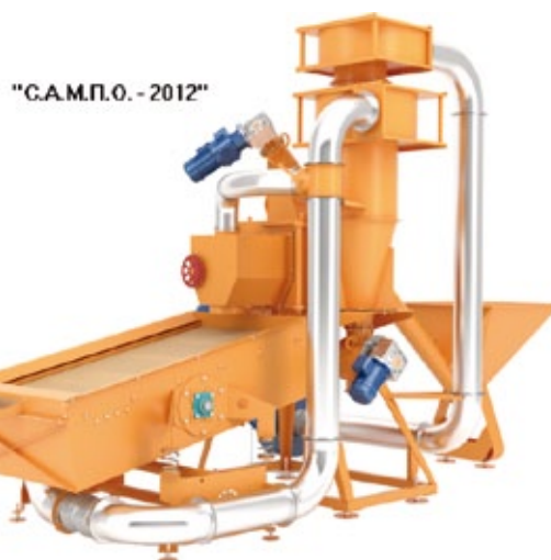
Рис. 1. Мельница-нагреватель для переработки растительного сырья
