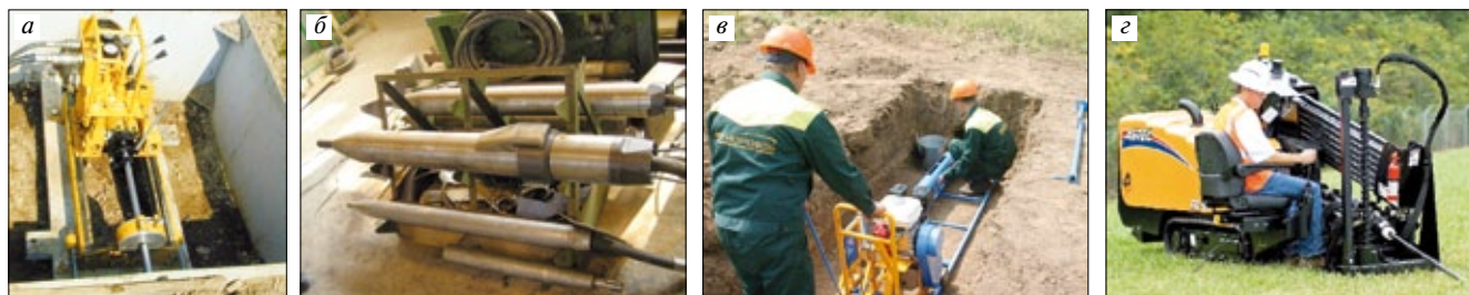
Рис. 2. Примеры машин для бестраншейной прокладки скважин: а – домкрат-гидроцилиндр; б – пневмопробойник; в – машина горизонтального бурения; г – машина ГНБ
