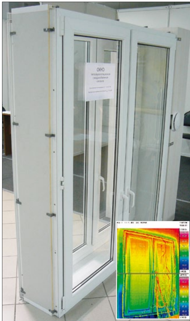
Общий вид теплоукоизоляционного окна с воздухообменным клапаном и термограмма внутренней поверхности окна
