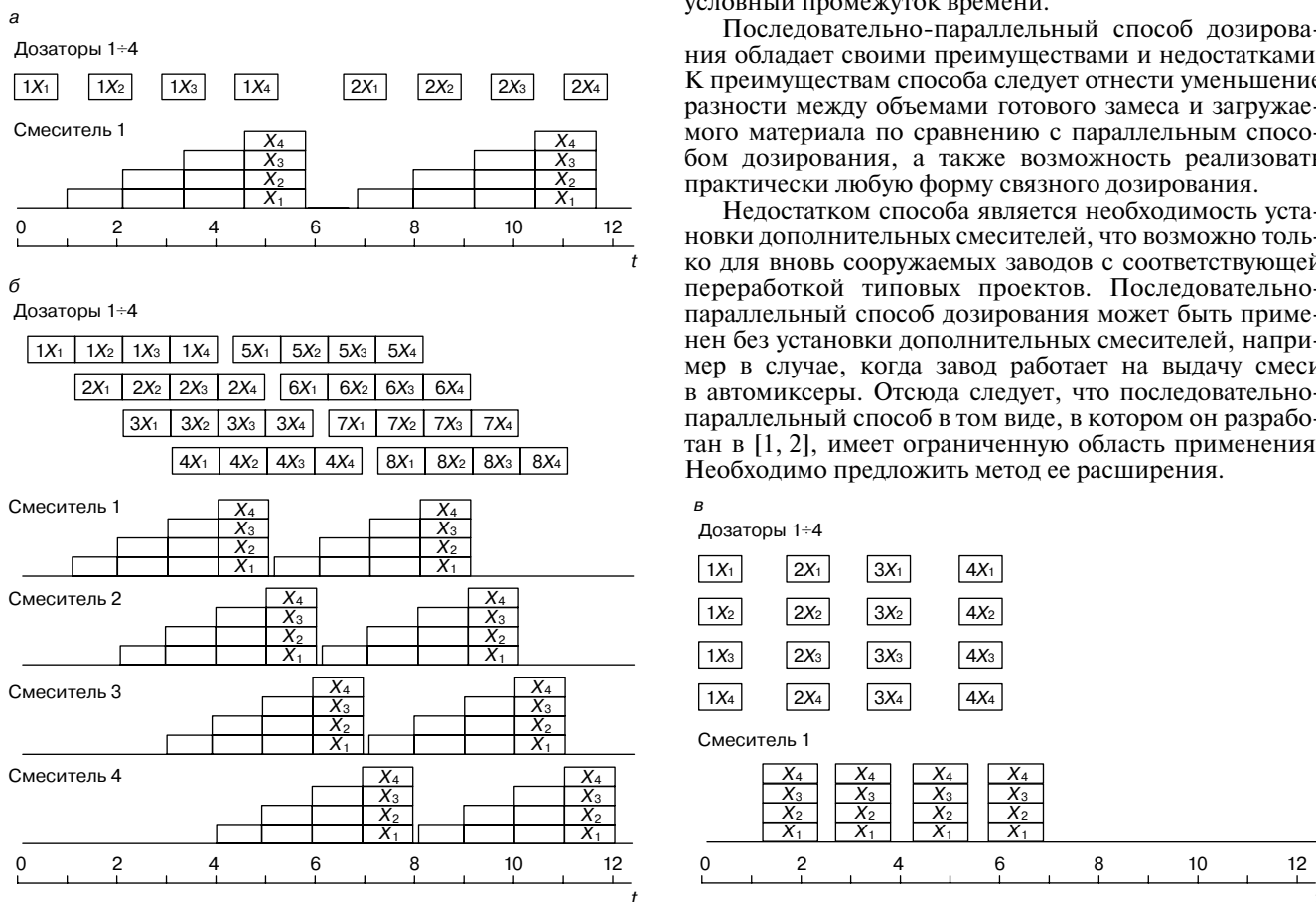
Рис. 1. Циклограммы работы дозаторов и смесителей при различных способах дозирования компонентов бетонной смеси: а – последовательное дозирование; б – последовательно-параллельное дозирование; в – параллельное дозирование; 1, 2, 3, 4, 5, 6, 7, 8 – номер замеса; X_1, X_2, X_3, X_4 – масса и номер компонента
