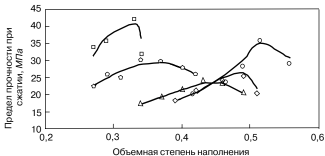
Рис. 2. Зависимость прочности жидкостеклового материала от объемной степени наполнения: □ – S_{уд}=350 \text{ м}^2/\text{кг} ; ○ – S_{уд}=240 \text{ м}^2/\text{кг} ; △ – S_{уд}=150 \text{ м}^2/\text{кг} ; ◇ – S_{уд}=65 \text{ м}^2/\text{кг} ; ○ – S_{уд}=55 \text{ м}^2/\text{кг}
