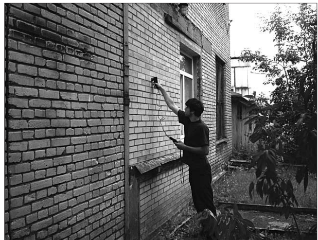
Рис. 2. Фрагмент испытываемой стеновой конструкции, размещенный в проеме существующего здания
