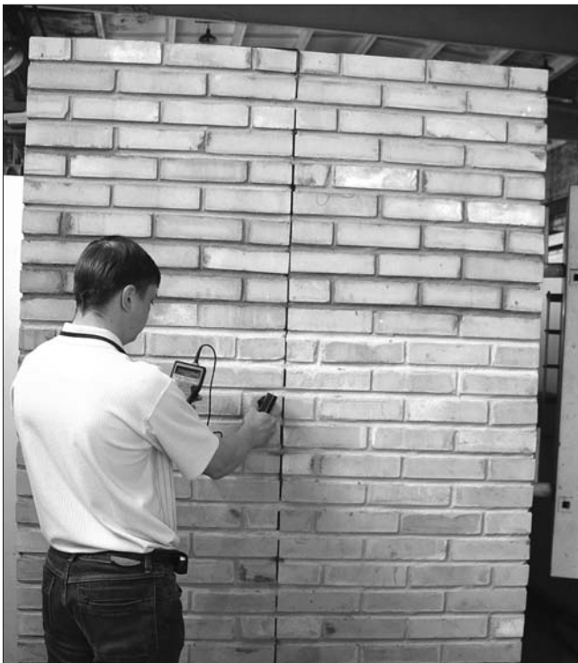
Рис. 3. Крупноразмерный фрагмент стеновой конструкции для лабораторных испытаний
