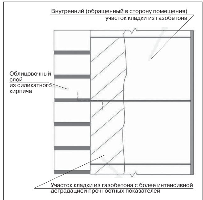
Рис. 5. Схема разрушения испытываемой стеновой конструкции
