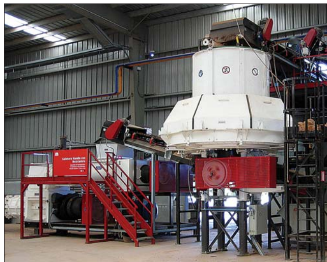
Часть линии формования, включающая глинорастиратель BRSH 19b
