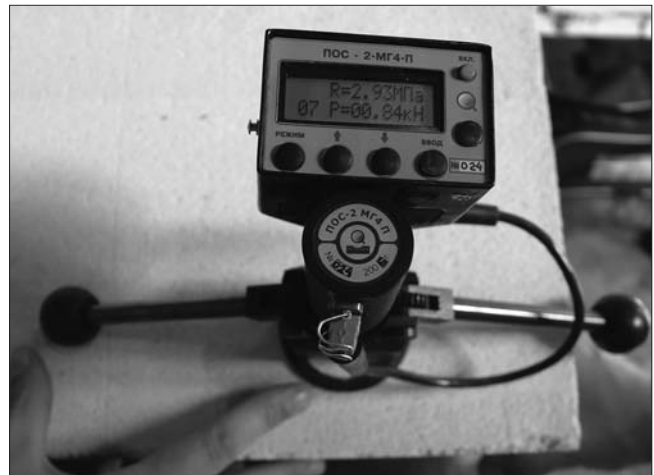
Рис. 4. Анкерное устройство для определения прочности газобетонной части стеновой конструкции
