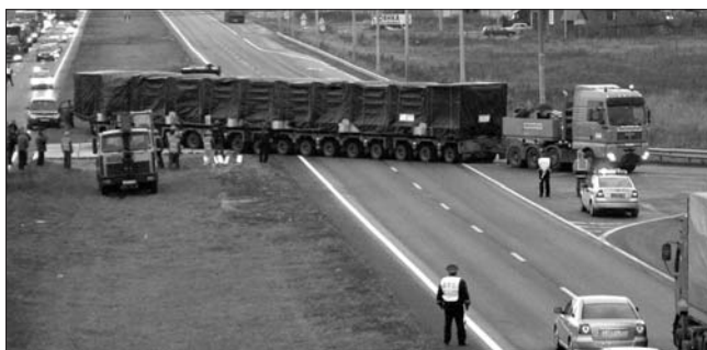
Рис. 1. Перевозка оборудования для Шатурской ГРЭС автопоездом, имеющим 22 оси и полную массу около 200 т
