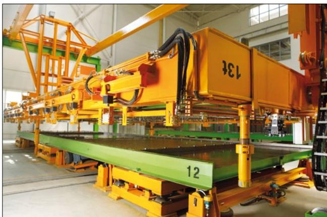
Рис. 2. Перевертывающая станция
