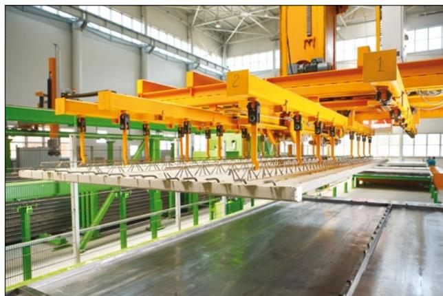
Рис. 3. Элемент НЖБО на конвейере
