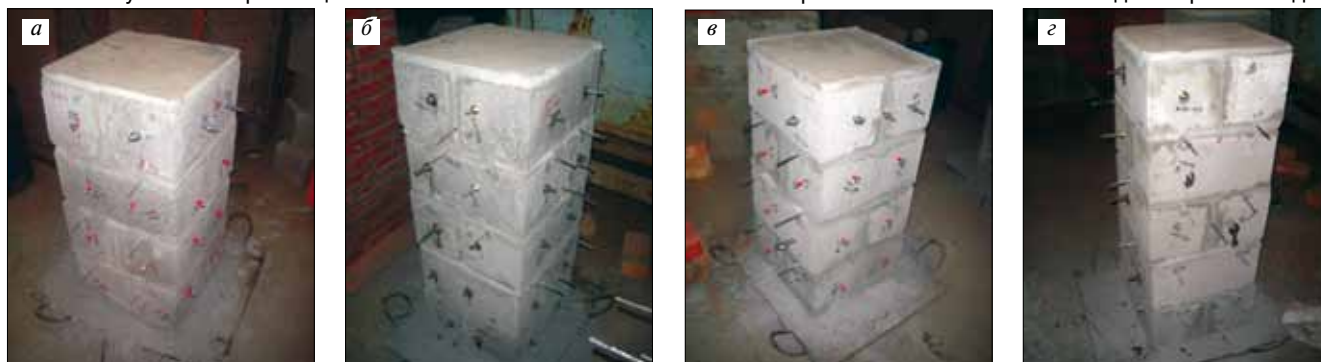
Рис. 1. Экспериментальные образцы-столбы сечением 410×400 мм на основе стеновых блоков из легкого бетона на гранулированном пеностекле марки «Неопорм»: а, б — из блоков плотностью D600, прочностью В2; в, г — из блоков плотностью D800, прочностью В5
