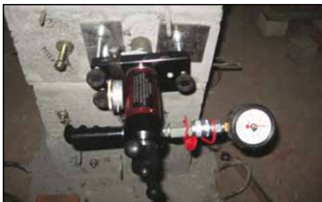
Рис. 3. Испытание химических анкеров Mungo в кладке блоков легкого бетона на стекловидных заполнителях марки «Неопорбетон».
