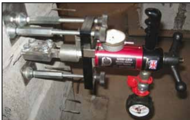
Рис. 5. Испытание гибких связей из базальто-пластиковой арматуры, установленных в растворные швы кладки стеновых блоков из легкого бетона на стекловидных заполнителях марки «Неопорбетон»
