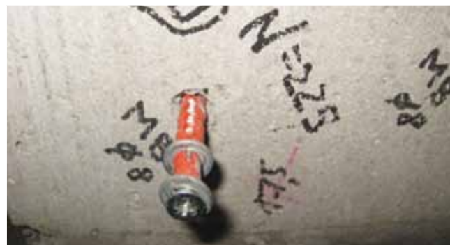
Рис. 4. Испытание распорных полиамидных дюбелей Mungo, установленных в кладку блоков легкого бетона на стекловидных заполнителях марки «Неопорбетон».
