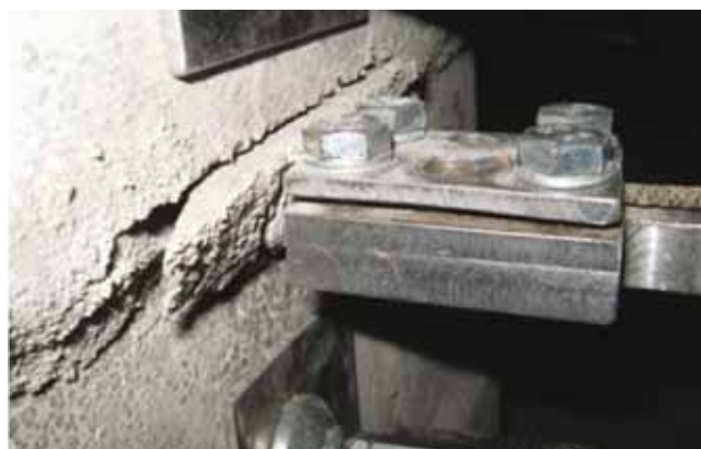
Рис. 5. Испытание гибких связей из базальто-пластиковой арматуры, установленных в растворные швы кладки стеновых блоков из легкого бетона на стекловидных заполнителях марки «Неопорбетон»
