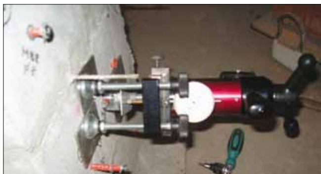
Рис. 4. Испытание распорных полиамидных дюбелей Mungo, установленных в кладку блоков легкого бетона на стекловидных заполнителях марки «Неопорбетон».
