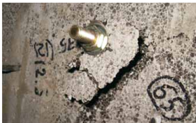
Рис. 3. Испытание химических анкеров Mungo в кладке блоков легкого бетона на стекловидных заполнителях марки «Неопорбетон».
