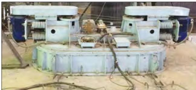
Рис. 4. Общий вид вибромашины инерционного действия ВИД-50
