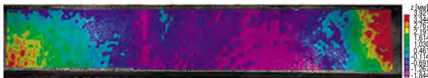
Рис. 7. Область анализа измерений прогибов ригеля системой VIC-3D
