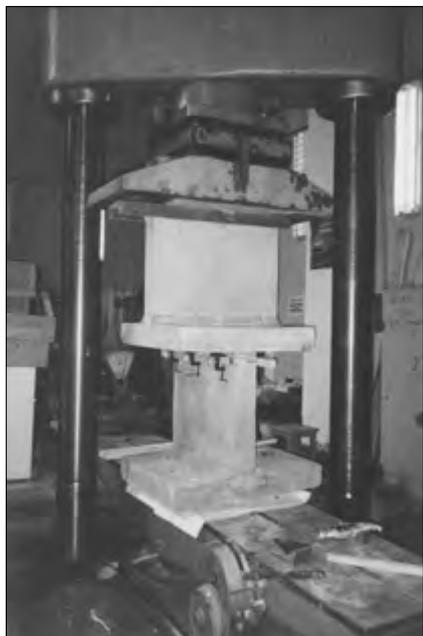
Рис. 3. Экспериментальный образец горизонтального стыка
