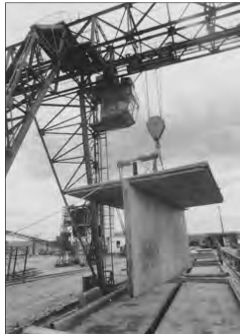
Рис. 1. Общий вид пространственного элемента после выемки его из формы
