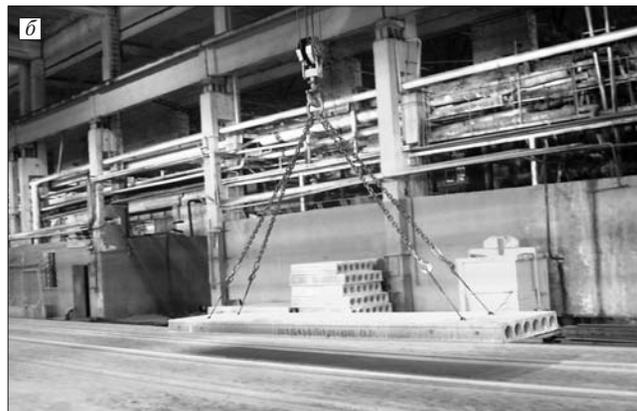
Рис. 1. Транспортировка плит: а – с помощью траверсы; б – с помощью КП
