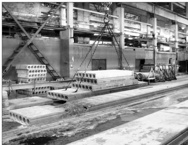
Рис. 6. Испытание КП нагружением
