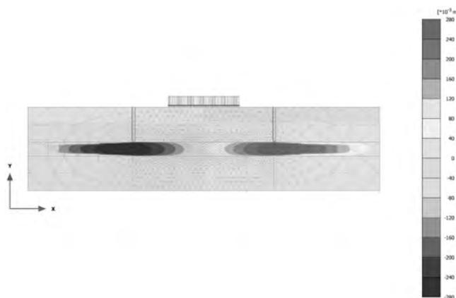
Рис. 5. Изополя горизонтальных перемещений массива грунта после нагружения
