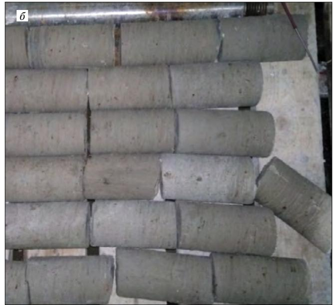
Рис. 3. Процесс устройства закрепления (а); керны цементогрунта (б)
