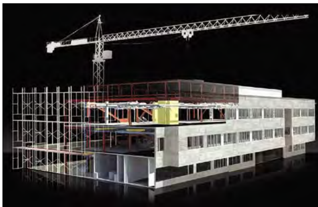
Рис. 5. Построение 4D-модели интерактивного ППР монтажа модульного здания как основы для создания 5D на основе BIM-технологий
