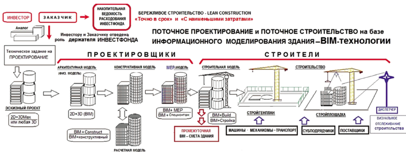
Рис. 1. Схема проектирования интерактивного проекта производства работ высокоскоростного возведения зданий из модульных систем на основе BIM-технологий
