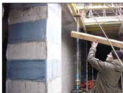
Рис. 1. Возбуждение свободных колебаний колонн
