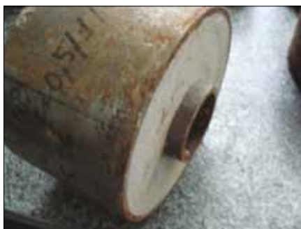
Рис. 6. Характер разрушения контакта образца с гладкой трубой
