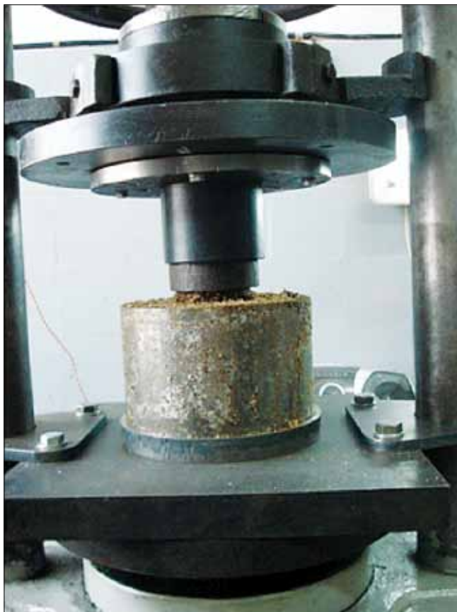
Рис. 4. Испытательная установка на выдавливание трубы из цемента
