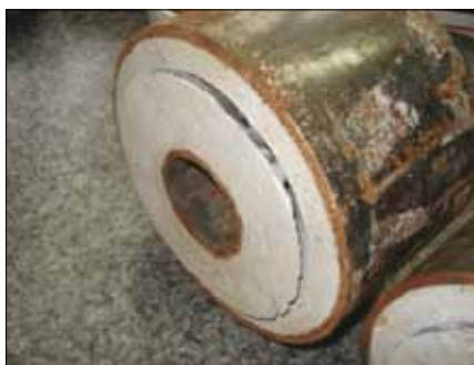
Рис. 7. Характер разрушения образца с арматурными элементами
