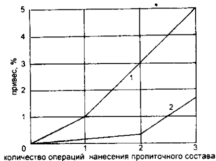
Рис. 3. Эффективность поверхностной огнезащитной пропитки древесины при использовании метода окунания (1) и при кистевом нанесении (2)
