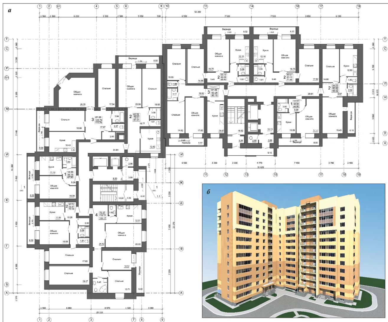
Рис. 4. Жилой дом по ул. Буинская: а – планировка квартир; б – общий вид
