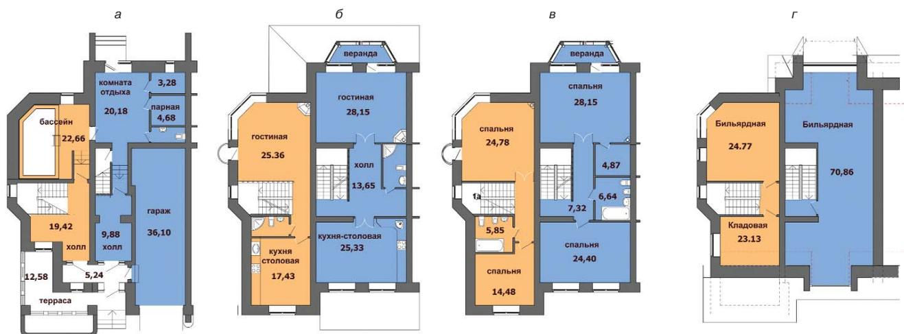
Рис. 3. Поэтажная планировка торцевых блок-квартир: а – 1-й этаж; б – 2-й этаж; в – 3-й этаж; г – мансардный этаж
