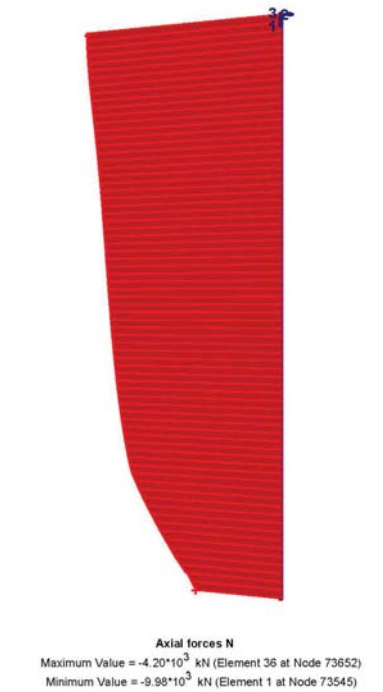
Рис. 5. Распределение вертикальной осевой силы по длине барреты
