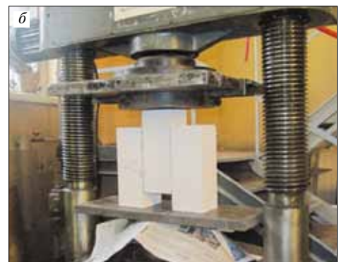
Рис. 5. Схема склейки трех призм из бетона для определения касательного сцепления материала кладочного шва (а) и стенд для испытаний материала кладочного шва и бетона на срез (б)
