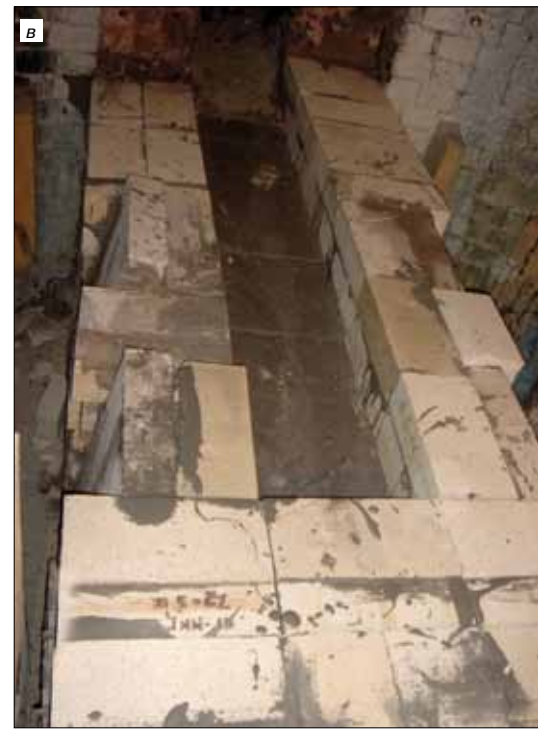
Рис. 3. Шахтная печь №1 с керамическим керном производительностью 90 т/сут: а – шахтная печь; б – поперечное сечение части керамического керна; в – вид сверху канала 20 керна 17 с поперечной стенкой; г – расположение горелок в шахте по сечениям III-III и IV-IV; 1 – питатель пластинчатый; 2 – футеровка; 3 – теплоизоляционный кирпич; 4 – топочная горелка; 5 – окна керна; 6 – кожух шахты; 7 – распределительный конус; 8 – патрубок отбора печных газов; 9 – предохранительно-взрывной клапан; 10 – двухклапанный механизм загрузки сырья; 11 – ствол скипового подъемника; 12 – отверстие для датчика радиоизотопного уровнемера сырья; 13 – люк для ремонтных работ; 14 – опорное кольцо; 15 – периферийная горелка; 16 – центральная керновая горелка; 17 – керамический керн; 18 – кладка из шамотного кирпича БУ; 19 – фундамент печи; 20 – жаровочный канал керна; 21 – перфорированный кожух питателя; 22 – конвейер ленточный
