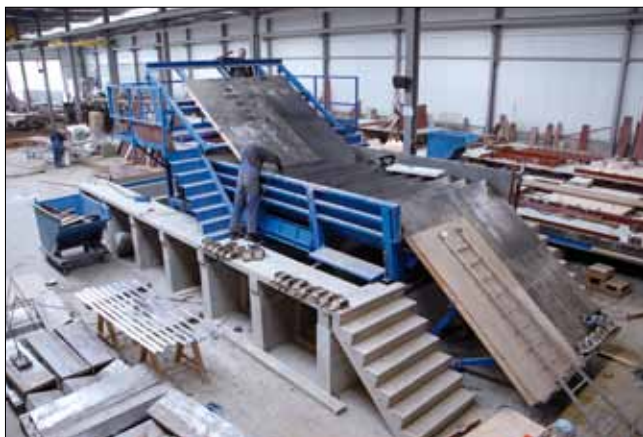
Полностью гидравлически регулируемые формы для лестниц для OMG Prefabbeton в Десселе (Бельгия)
