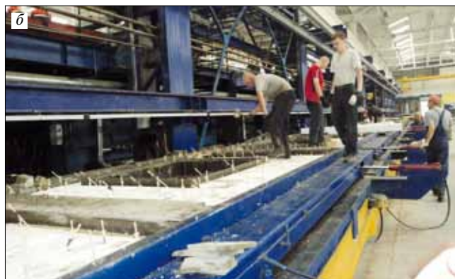
Рис. 1. Трехслойная теплоэффективная панель: а – схема; б – производство
