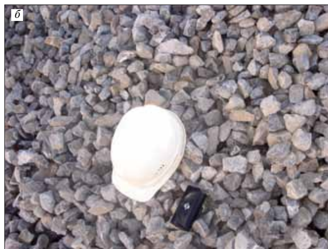
Рис. 2. Фотографии загружаемого в шахтные печи известняка фракции 30–50 мм: а – до реконструкции дробильно-сортировочного узла; б – после реконструкции
