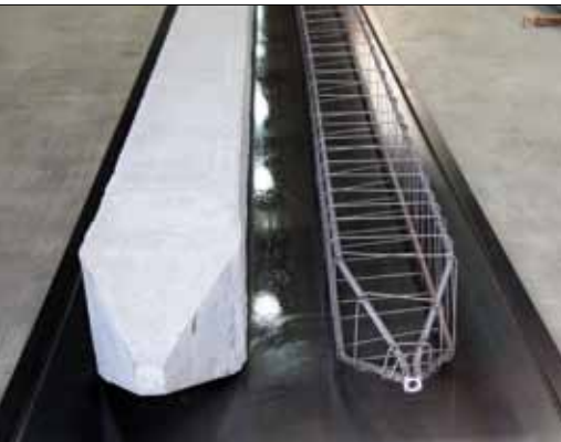
Производство бетонных остроконечных свай
