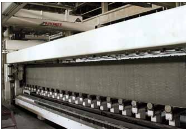
Самый большой завод в Восточной Европе («Энерджи Продакт», Украина): резательная линия (с двумя струнами) и горизонтальное автоклавирование позволяют сделать поверхность любой продукции AIRCRETE СУПЕРГЛАДКОЙ
