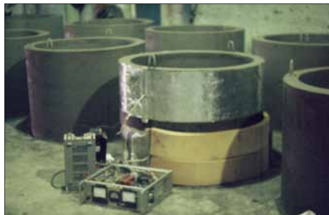
Рис. 4. Эксперимент по электротепловой обработке железобетонных колец
