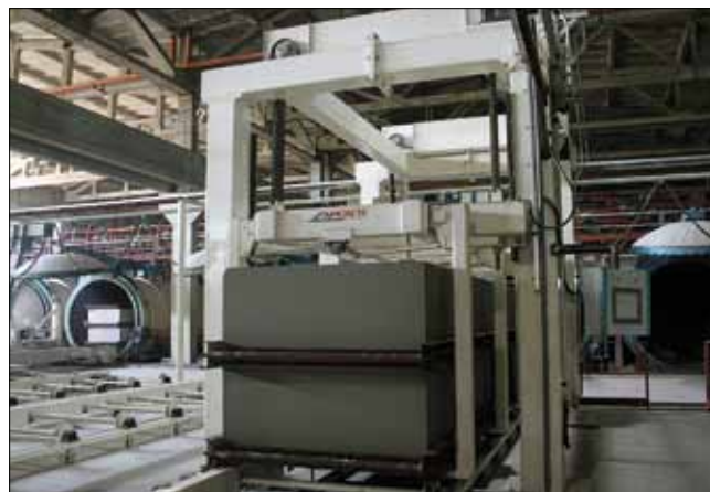
Самый большой завод в Восточной Европе («Энерджи Продакт», Украина): резательная линия (с двумя струнами) и горизонтальное автоклавирование позволяют сделать поверхность любой продукции AIRCRETE СУПЕРГЛАДКОЙ
