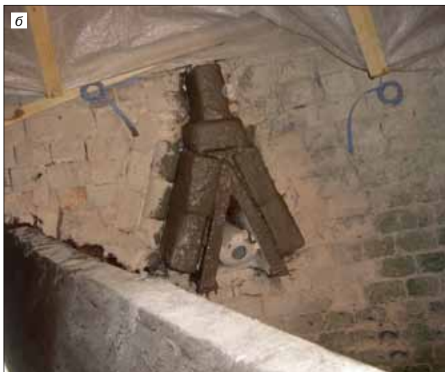
Рис. 5. Внешний вид периферийной горелки Бортникова: а – снаружи печи; б – в зоне обжига
