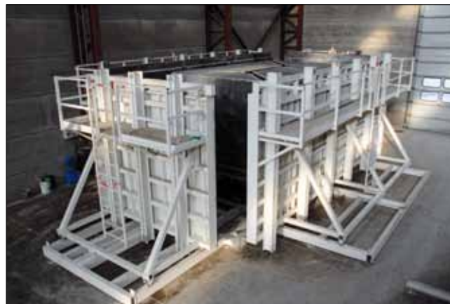
Регулируемая, гидравлически сжимаемая форма для ливневых резервуаров для O Beton в Румбеке (Бельгия)
