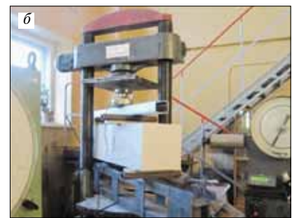
Рис. 4. Схема (а) и стенд для проведения испытаний (б) балок на изгиб
