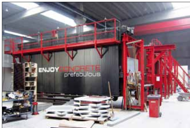
Установка двух вертикальных кассетных форм Hibat на современном заводе Enjoy concrete, производящем сборный бетон в Верне (Бельгия)
