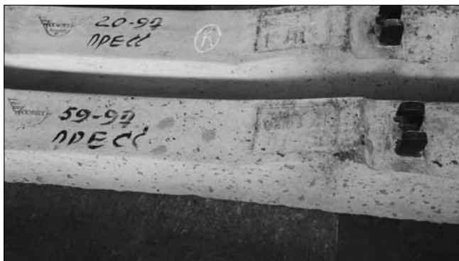
Изменение поверхности железобетонных шпал при незначительном изменении способа модификации и удобоформируемости бетонной смеси
