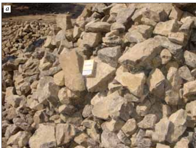
Рис. 2. Фотографии загружаемого в шахтные печи известняка фракции 30–50 мм: а – до реконструкции дробильно-сортировочного узла; б – после реконструкции
