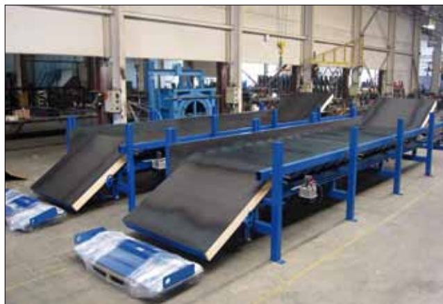
Регулируемая бюджетная лестничная форма, оснащенная гидравлическим ручным насосом
