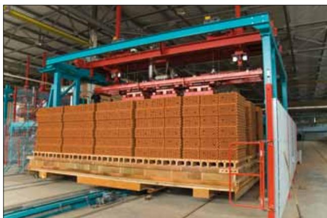
Автоматизированная разгрузка печных вагонеток
