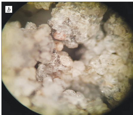
Рис. 2. Структура бетона на вторичном щебне без добавки: 6,5-кратное (а) 50-кратное (б) увеличение Fig. 2. Concrete structure on secondary gravel without additives: 6.5× (a) 50× (b) magnification
