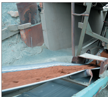
Рис. 2. Загрузка компонентов и получение смеси на основе диспергированного битума Fig. 2. Loading components and obtaining a mixture based on dispersed bitumen
