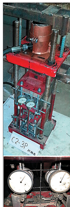
Рис. 3. Схема установки приборов для измерения перемещений [12, 14] Fig. 3. Diagram of installation of devices for measuring movements [12, 14]
