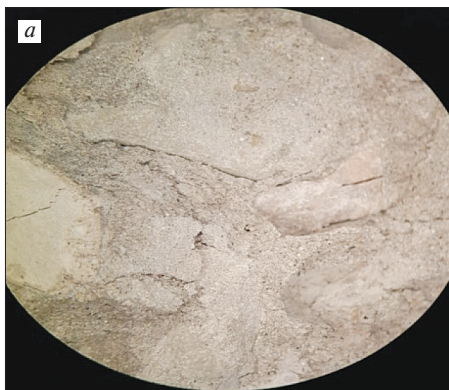
Рис. 2. Структура бетона на вторичном щебне без добавки: 6,5-кратное (а) 50-кратное (б) увеличение Fig. 2. Concrete structure on secondary gravel without additives: 6.5× (a) 50× (b) magnification
