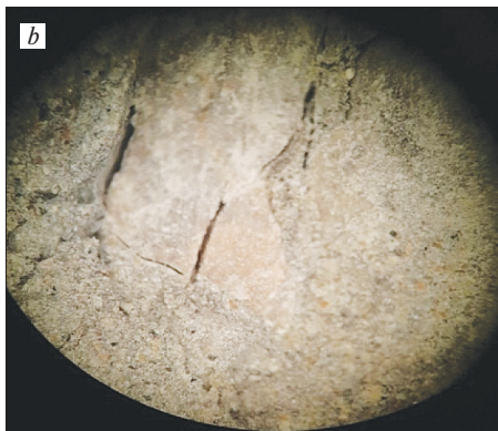
Рис. 3. Структура бетона на вторичном щебне с применением добавки Силор-Ультра Т в количестве 5%: 6,5-кратное (а) 50-кратное (б) увеличение Fig. 3. Concrete structure on the secondary gravel using Silor-Ultra T addition: 6.5× (a) 50× (b) magnification
