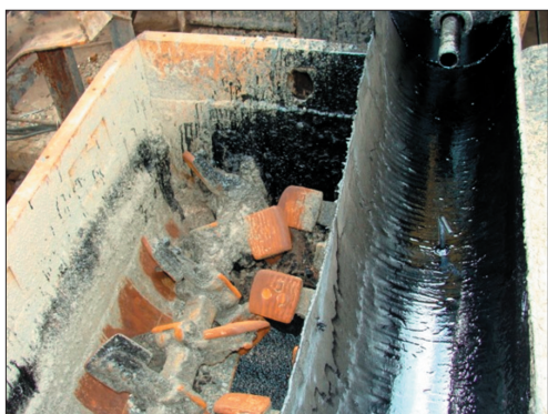
Рис. 1. Мешалка с опрокидывающимся дозатором вяжущего Fig. 1. Mixer with tipping binder dispenser
