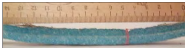
Рис. 6. Слой из смеси сухого дробленого песка фракции 0–3 мм, перемешанного с битумной суспензией
