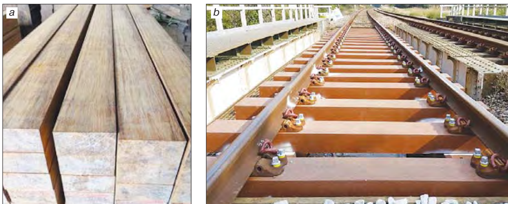
Рис. 10. Конструкции гомогенных композиционных подрельсовых оснований с длинными волокнами: а – консолидированные бамбуковые основания [22, 75]; б – SEKISUI FFU-синтетические основания [19]
