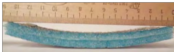
Рис. 5. Слой из битумной суспензии, армированной фиброй Fig. 5. A layer of fiber-reinforced bitumen suspension
