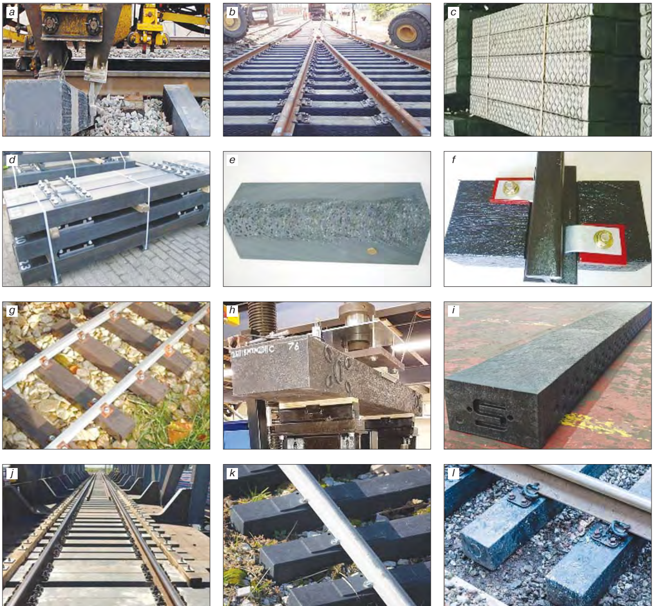
Рис. 9. Конструкции однородных композиционных подрельсовых оснований с короткими волокнами: a – IntegriCo-композитная шпала [10]; b – то же, Axion [65]; c – то же, TieTek [66]; d – то же, I-PLAS [67]; e – то же, MPW [68]; f – то же, Tufflex [69]; g – то же, из натурального каучука [17]; h – Duratrack-полимерная шпала [70]; i – SICUT-пластиковая шпала [71]; j – мостовой пластиковый брус компании Tianjin Yanwen Weiye [72, 73]; k – пластиковая трамвайная шпала [74]; l – композитные шпалы производства компании TVEMA [8]
