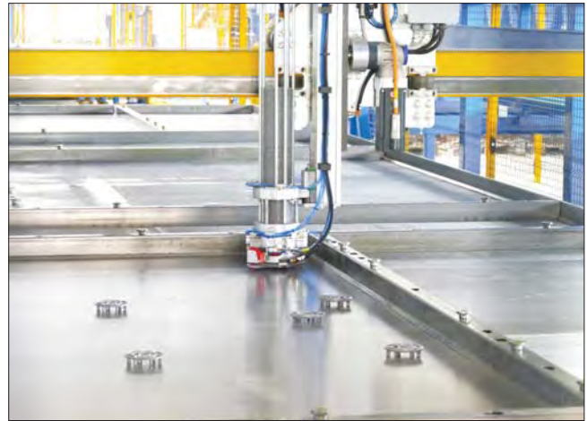
Полностью автоматическая укладка фиксаторов с помощью робота MeshSpacer позволяет компании EDER добиться существенной экономии Fully automatic placement of anchors with the MeshSpacer robot enables EDER to achieve significant savings
