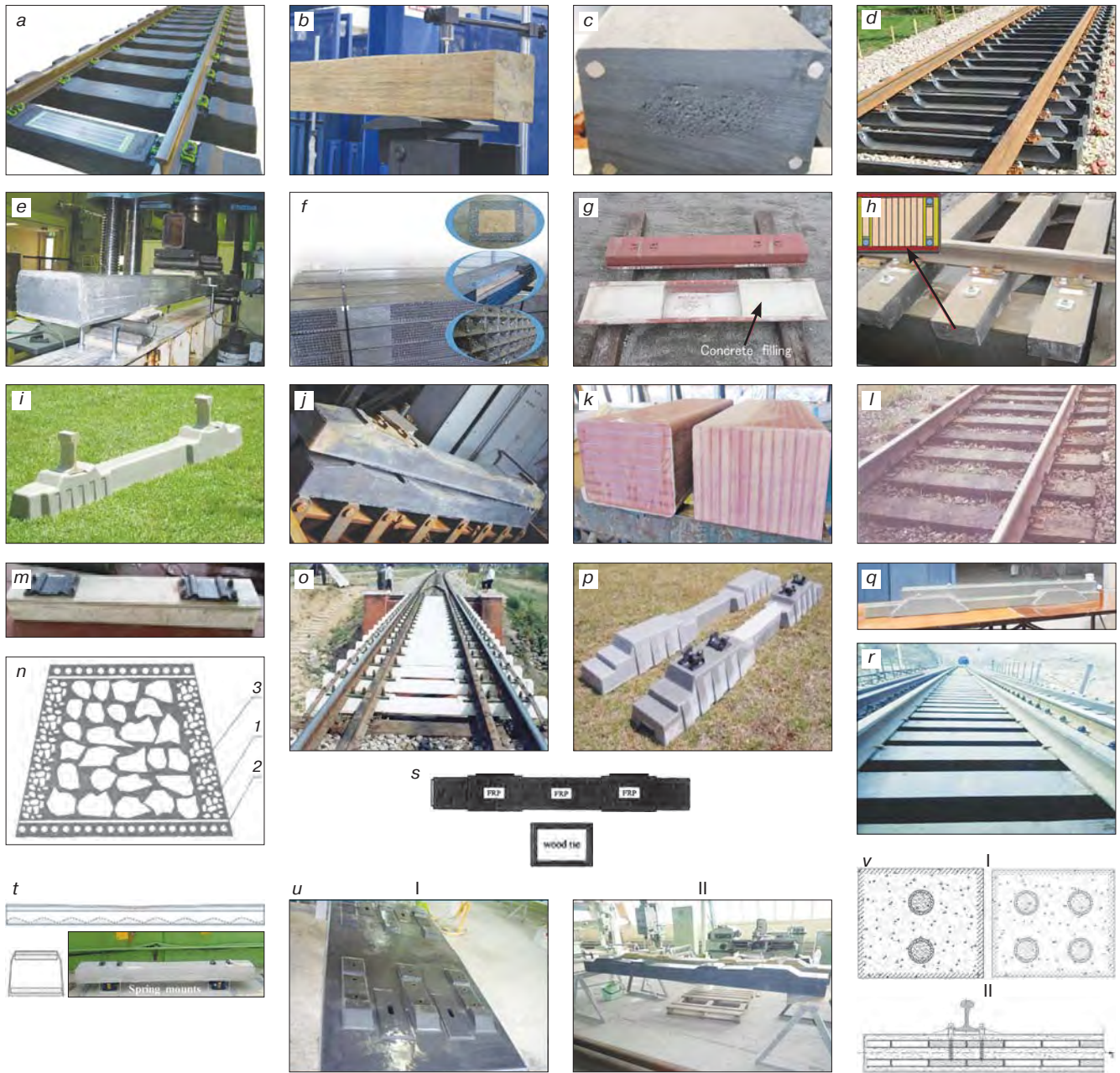
Рис. 11. Конструкции гибридных композиционных подрельсовых оснований: a – Greenrail-шпалы из ж/б сердцевин с полимерной оболочкой [11]; b – консолидированный бамбуковый брус, армированный четырьмя стержнями [76]; c – то же, KLP-мостовой брус [77]; d – KLP-композитная шпала, армированная двумя стержнями [78]; e – полые полимерные профили, заполненные геополимерным бетоном [79]; f – композитная шпала с деревянными брусками [80]; g – стальной желоб, заполненный бетоном [81]; h – мостовые брусья из клееных деревянных досок, усиленных четырьмя арматурными стержнями [82]; i – шпала из клееных деревянных досок и полимербетона [31]; j – пластиковая шпала, армированная полым металлическим брусом [83]; k – композиционный ламинированный мостовой брус из древесины [18]; l – композитная шпала, армированная двумя деревянными брусками [83]; m – ламинированный композитный мостовой брус из полимера, стеклотекстиля, багасы и шелухи какао [23]; n – сечение композиционной шпалы, состоящей из полимербетонной матрицы (1), армирующей стеклотекстиля (2) и древесного наполнителя (3) [84]; o – Permal Wallace-пластиковый мостовой брус, армированный волокнами [85]; p – композиционная шпала из полимербетона и стекловолокна [86]; q – шпала из композитных сэндвич-панелей, стекловолокна и смолы [31]; r – деревянная шпала, покрытая полиуретановым эластомером [87]; s – шпала из деревянной сердцевинки и стеклокомпозита [88]; t – шпала из ж/б и полимербетона в форме волны [89]; u – безбалластное мостовое полотно (I) и мостовой брус (II) из композитных материалов [90]; v – поперечное (I) и продольное сечения (II) композиционного основания, армированного двумя и четырьмя бамбуковыми стержнями [91, 92]
