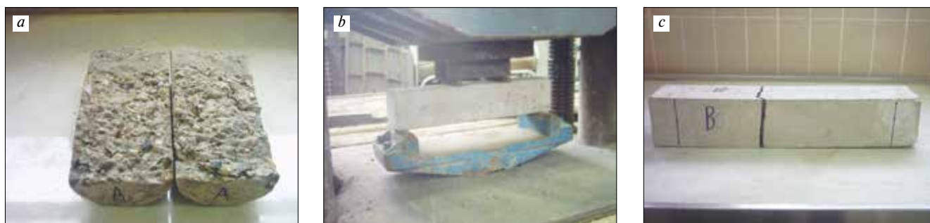
Рис. 2. Испытание образцов для определения прочностных характеристик бетона: a – цилиндрический образец после проведения испытаний на растяжение при раскалывании; b – общий вид испытаний для определения прочности на растяжение при изгибе; c – образец после проведения испытаний на растяжение при изгибе
