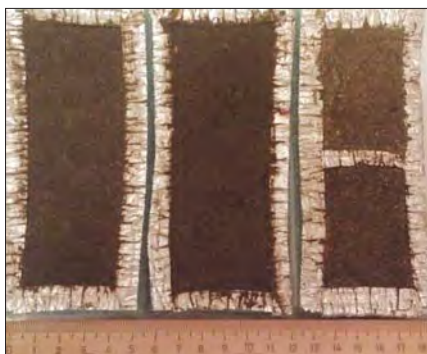
Рис. 7. Образцы битумных материалов на основе суспензии через 6 сут Fig. 7. Samples of bituminous materials based on a suspension after six days
