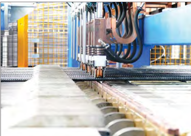
Производство арматурных сеток «точно в срок» на сеткосварочной установке BlueMesh фирмы Progress Maschinen & Automation Production of reinforcement meshes «Just-in-time» on a BlueMesh welding machine from Progress Maschinen & Automation
